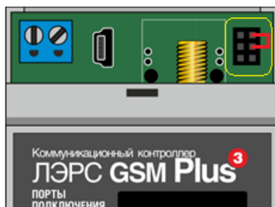
Рисунок 5.1 – Установка переключателя для обновления ПО
